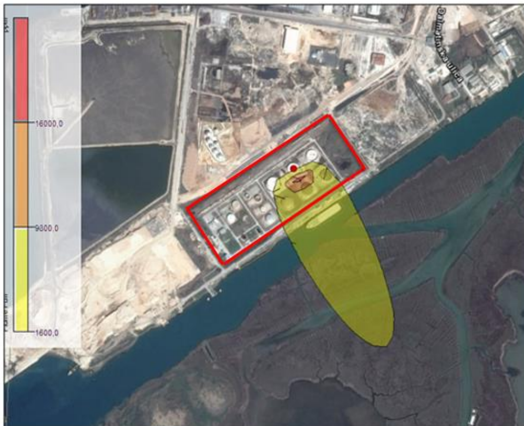
Slika 40. Disperzija oblaka zapaljivih/eksplozivnih para nakon 11,5 minuta
