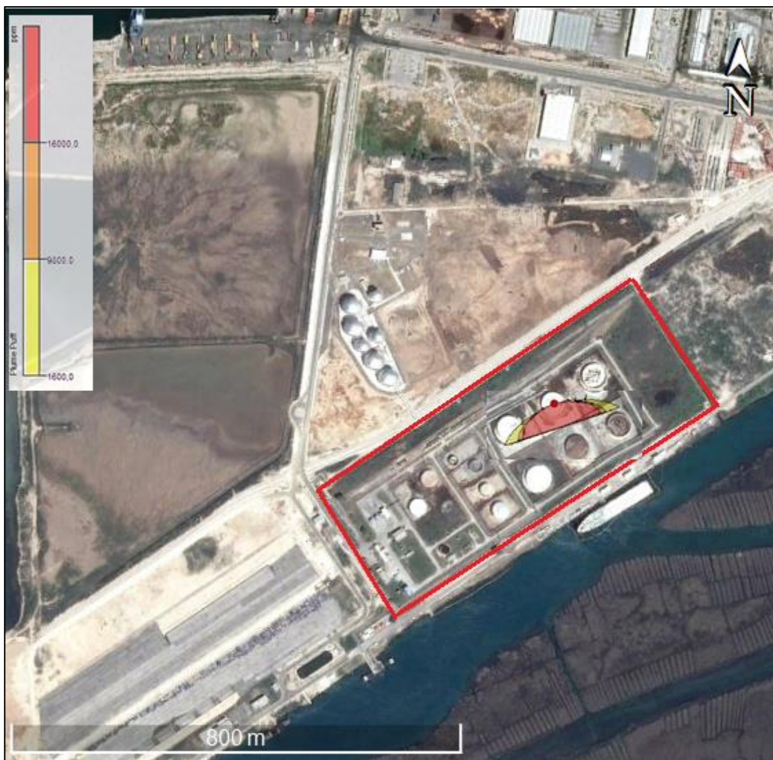
Slika 37. Disperzija oblaka zapaljivih/eksplozivnih para benzina u 30 sekundi
