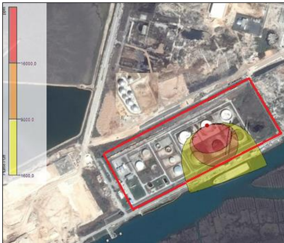
Slika 38. Disperzija oblaka zapaljivih/eksplozivnih para benzina nakon 2 minute
