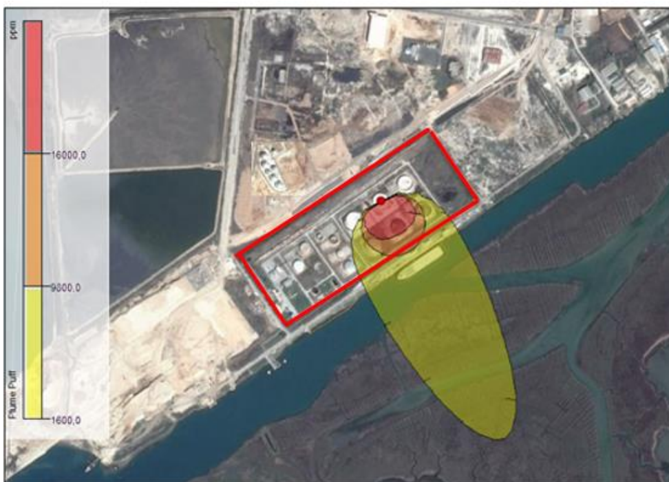
Slika 39. Disperzija oblaka zapaljivih/eksplozivnih para nakon 6,5minuta
