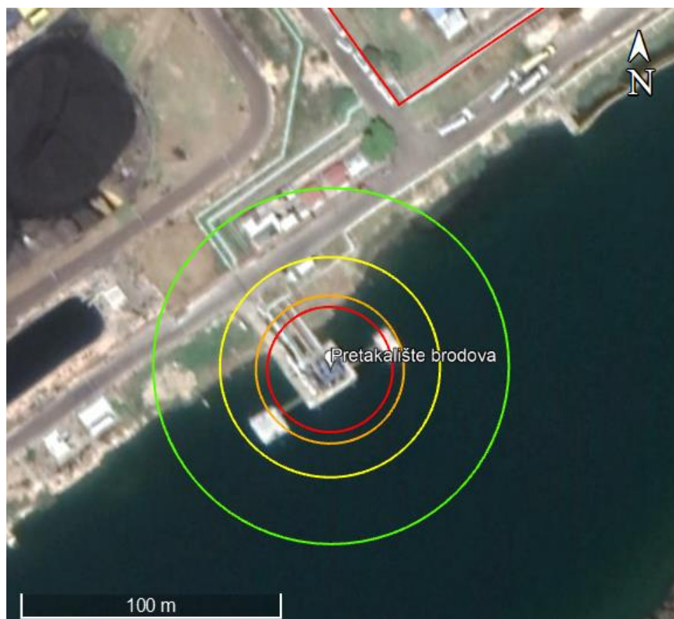
Slika 50. Zone ugroženosti uslijed eksplozije para benzina zbog loma utakačke ruke na lokaciji pretakališta brodova
